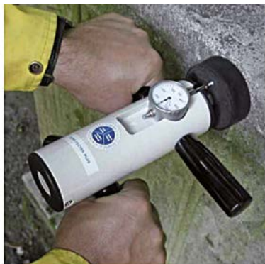
Halt von Grabsteinen prüft ein Kipp-Tester
